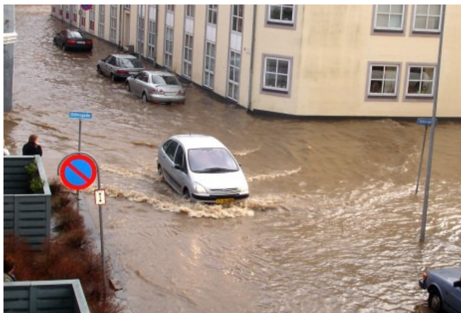
Figur 10.1 Eksempel på opstuvning af vand på terræn
